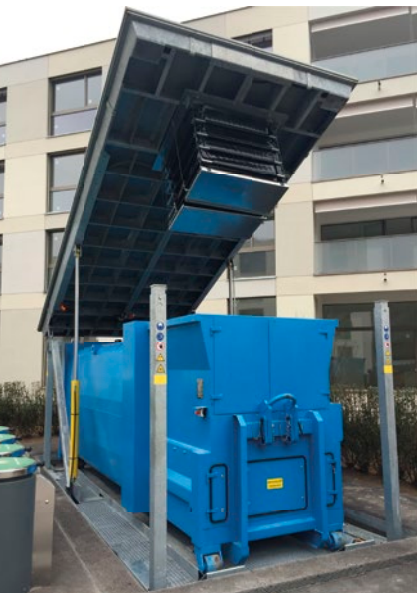
Presscontainer hoch- gefahren
